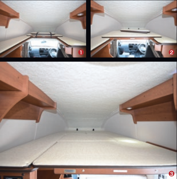
フロントバンクベッドは、パネル2枚を引き出すだけで簡単にセットできます。 (L1960×W1200～1600mm) 収納時は、寝具などの収納スペースとしても活用できます。
