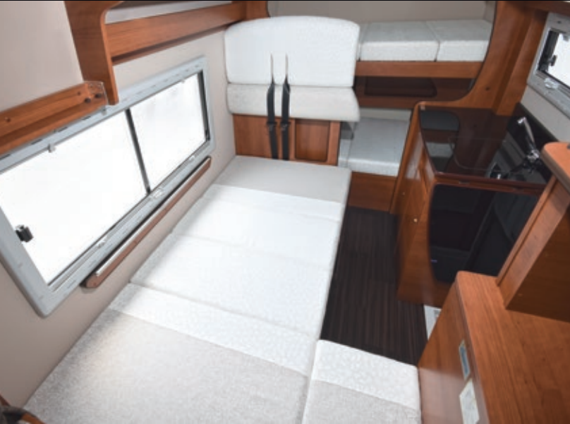
テーブルを外し、シートの間にセットして、その上に背もたれマット2枚を入れるとフロアベッドの完成です。 (L1880×W900mm)
